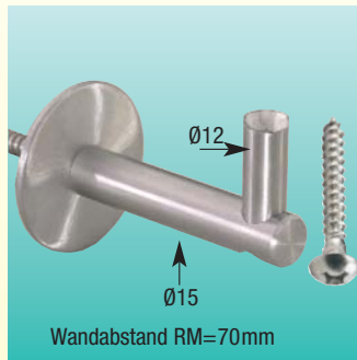
Handlaufhalter, V320, Ronde zentriert mit Stockschraube, Träger Ø 15 mm Grab rails-holder, V320, round blank centered w. stick screw, holder Ø15mm Art.-Nr. Ronde Ø 10990 50 x 3
